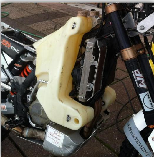
Le mono-réservoir avant de 14 litres sera remplacé par 2 réservoirs latéraux de 10 litres. Ce changement n'est pas absolument nécessaire.
