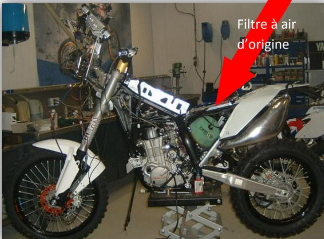
Toujours pour fiabiliser le moteur, la position du filtre à air est importante. Sur nos moteurs de motos d'enduro, le filtre à air est positionné latéralement entre le moteur et - surtout devant - la roue arrière. Dans nos chemins européens, cela ne pose pas de problème. Mais en Afrique ou dans les déserts sud-américains cela peut être fatal : le filtre reçoit énormément de sable.
