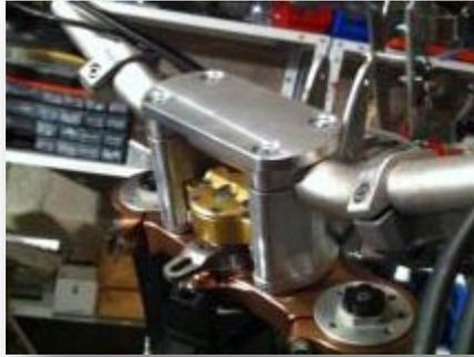
De plus, je peux ainsi ajouter un **amortisseur de direction**. L'amortisseur évite le guidonnage dans le sable. C'est moins de fatigue due à la force déployée pour contenir le guidon.
