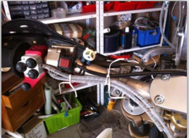
Je passe donc les câbles en les fixant temporairement avec des petits colliers plastique/métal. Cela permet de replacer les câbles à volonté jusqu'à ce que cela soit parfaitement réglé. N'étant pas électricien, j'essaie de soigner cette partie car je me vois mal faire du dépannage en plein désert !
