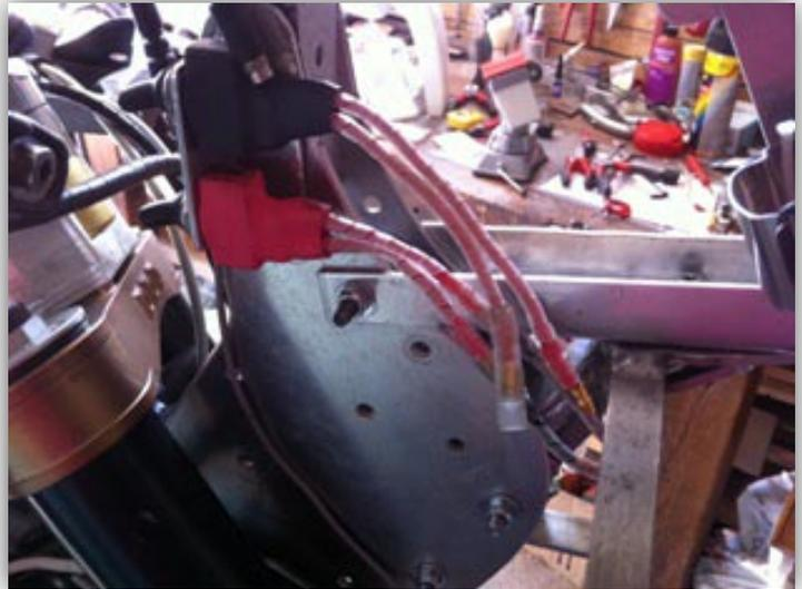
Tous les câbles sont à repositionner. J'essaie plusieurs solutions pour m'assurer qu'aucun câble ne vienne frotter ou se pincer.
